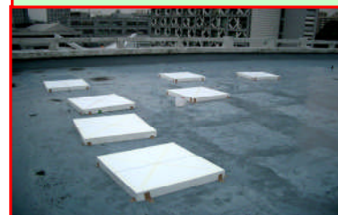
露の採取風景（早稲田屋上） 発泡スチロールにテフロンシートを貼ったもの
