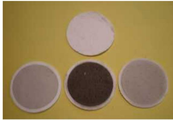
大気観測結果[24h 採取]: 海洋大気(下段両端), インド港大気(下段中央), 未使用フィルター(上)
